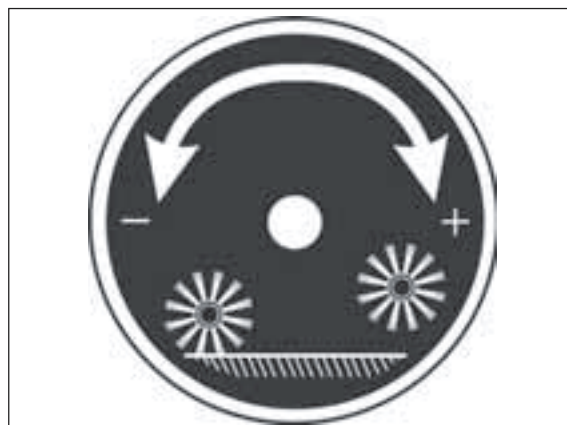
④ Drehen im Uhrzeigersinn (+) : Bürste anheben Entgegen dem Uhrzeigersinn (-) : Bürste absenken
